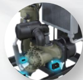
采用一体式整合的隔振系统，延长了压缩机使用寿命。
